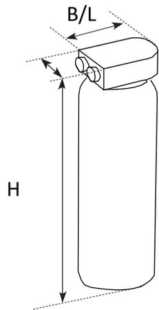
L'utilisation d'un °adoucisseur d'eau est nécessaire si la dureté de l'eau est supérieure à 6° DH.
